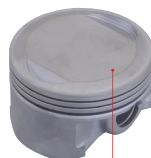
強度の向上と摺動抵抗軽減を図ったWPC+MOS2加工
